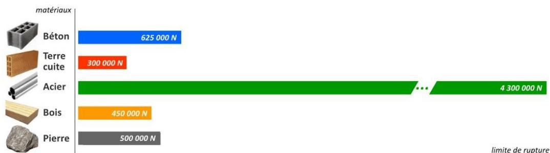
La résistance des matériaux se mesure en laboratoire par des tests. On applique sur chaque échantillon identique de matériau (éprouvette) un effort de plus en plus grand jusqu'à ce qu'il cède. On obtient la **limite de rupture** exprimée en **Newton (N)**.
